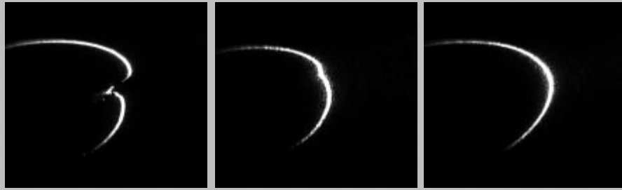
Bild 2: fehlerhaftes Teil mit RiB (links), mit Einschnürung (Mitte), Gut-Teil mit ausgeprägtem Kurvenverlauf (rechts)
